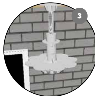
3. Positionner le cavalier et visser jusqu'au moins au repère minimum
