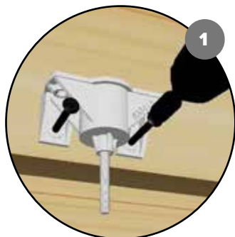
1. Fixer la suspente sur la charpente
