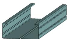
**Type (C)** : également appelés **fourrures**, ces profilés sont conçus pour la réalisation de l'ossature des ouvrages horizontaux ou inclinés, tels que les plafonds, les habillages, et les contre-cloisons avec appuis intermédiaires clipsés.
