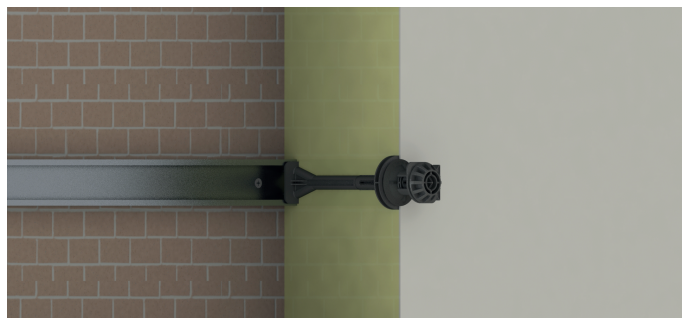
6. Régler la tête de l'appui puis la clipser
